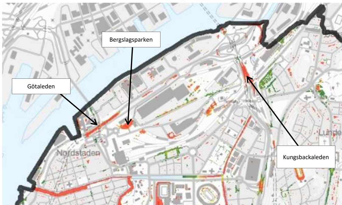
Figur 8. Beräknad varaktighet för med översvämningsdjup överstigande 0.2 m, utifrån dagens situation vid dimensionerande klimatanpassat 100-årsregn, för strukturplan Centrum Södra avrinningsområde (området avgränsas av svart linje i figur) (DHI & Sweco, 2018).
